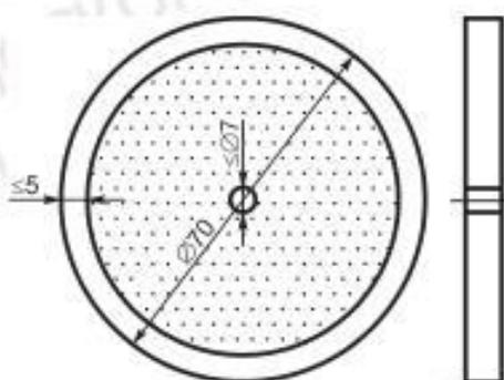
Рисунок Б.2 — Световозвращатель типа КД2
