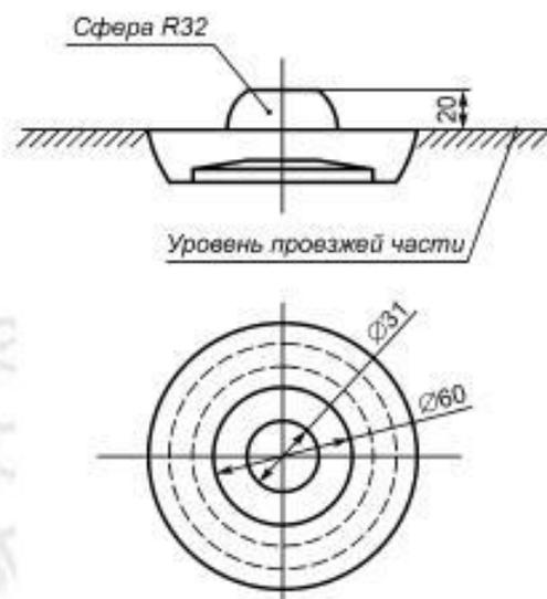
Рисунок Б.4 — Световозвращатель типа КД4
