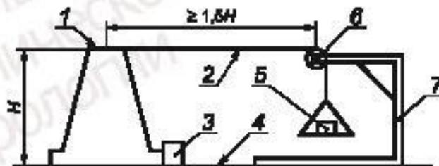
$H$  — высота временного дорожного барьера, временного дорожного щита, дорожного конуса, дорожной пластины, дорожной сигнальной вехи; 1 — временный дорожный барьер, временный дорожный щит, дорожный конус, дорожная пластина, дорожная сигнальная веха; 2 — шнур; 3 — упор; 4 — ровная горизонтальная поверхность; 5 — груз; 6 — блок; 7 — штатив
