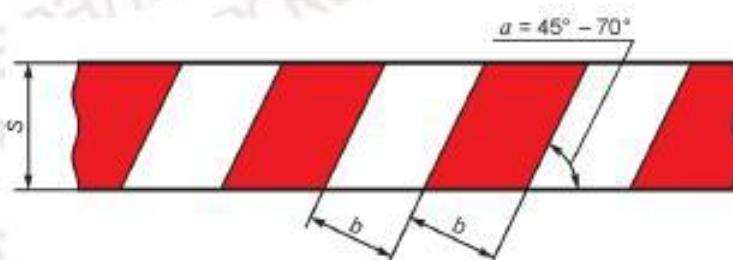
S — ширина дорожной ограждающей ленты, а — угол между красными, белыми полосами и продольной осью дорожной ограждающей ленты, б — ширина красных и белых полос на дорожной ограждающей ленте
