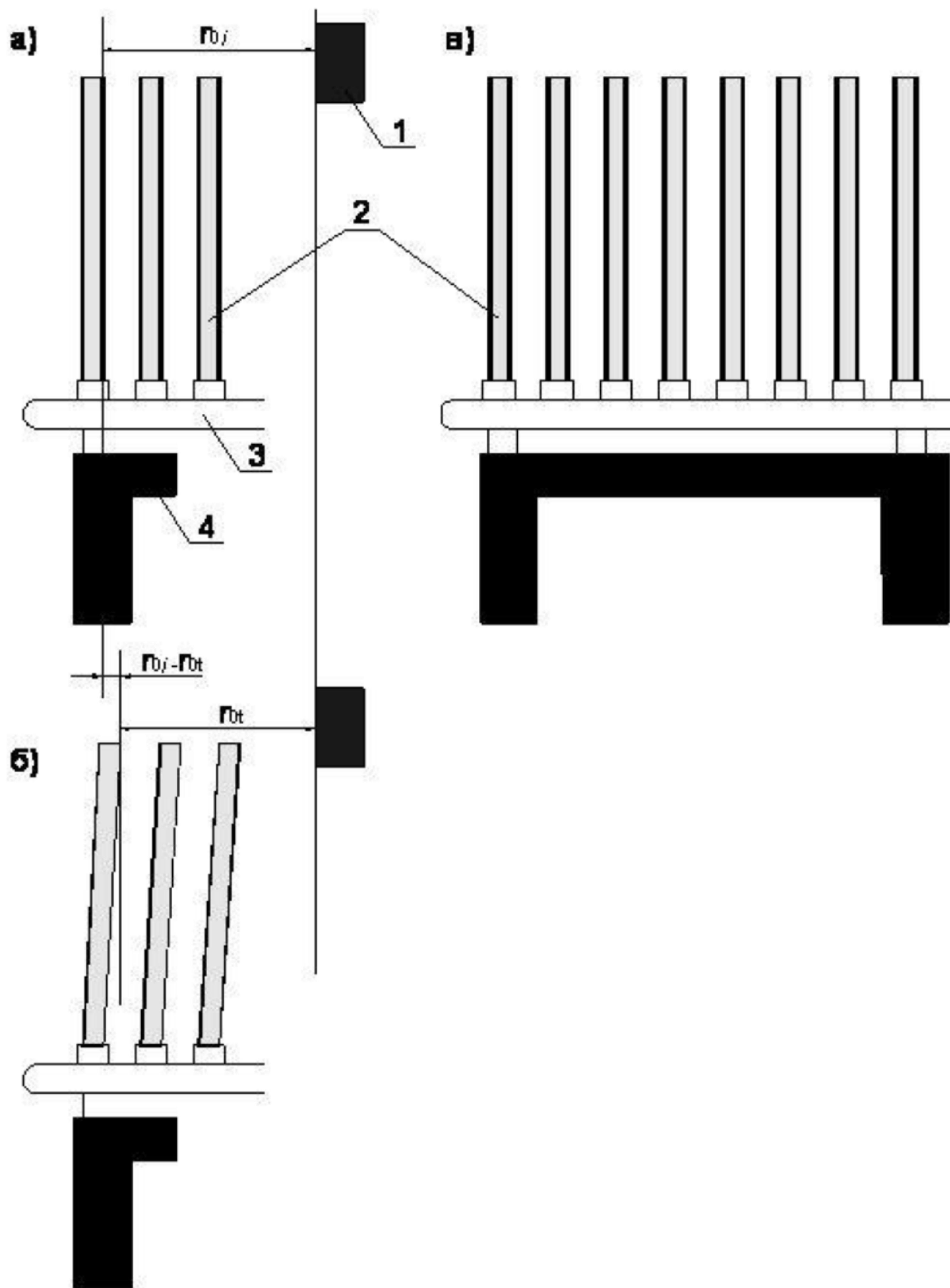
а) предварительное измерение; б) измерение после проведения испытания;
