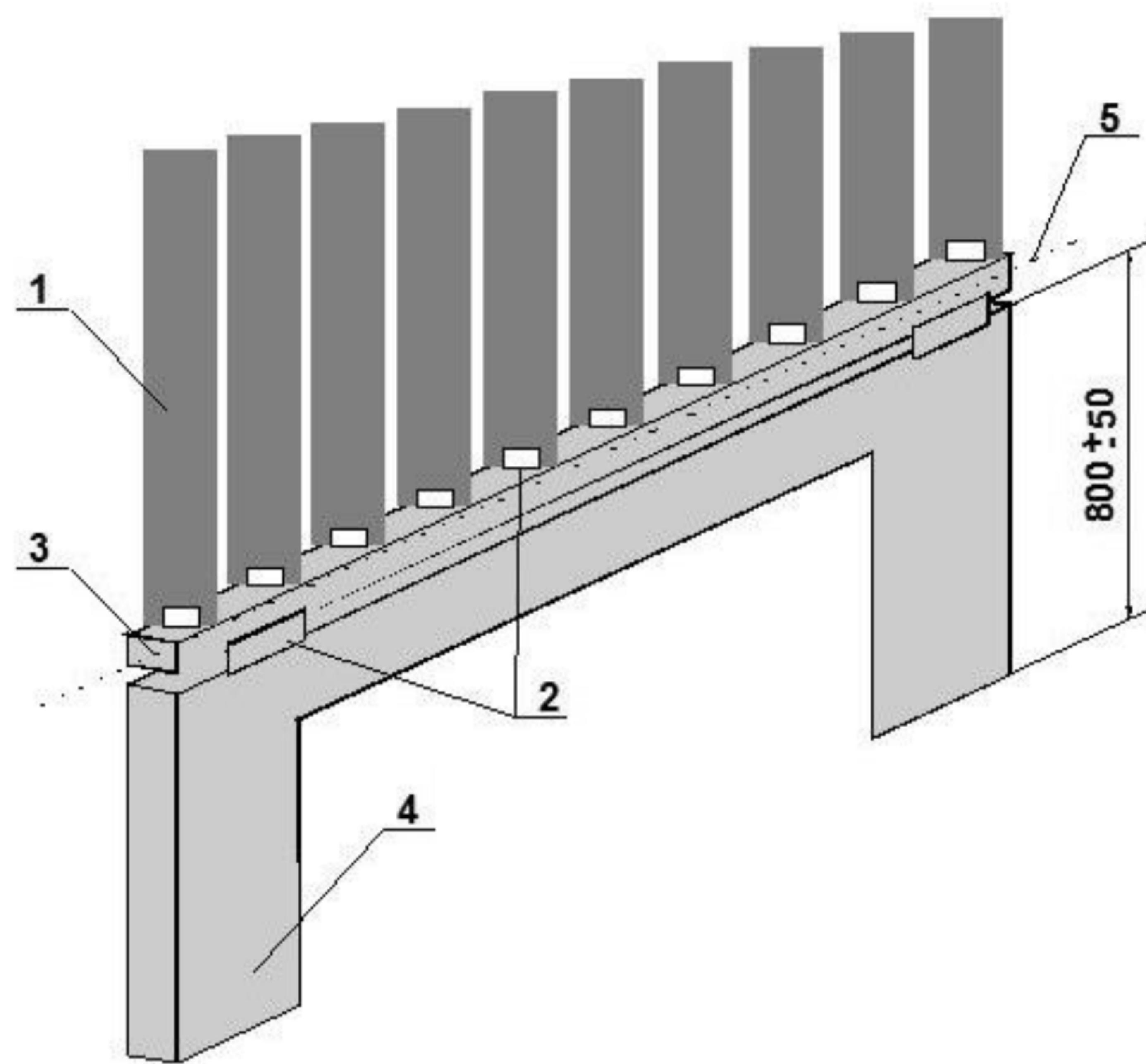
1 – затеняющий элемент; 2 – элемент крепления; 3 – опора; 4 – пример основы; 5 – главная ось системы
