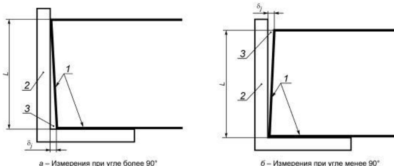
Рисунок 1 — Схема контроля взаимной перпендикулярности граней бортового камня
