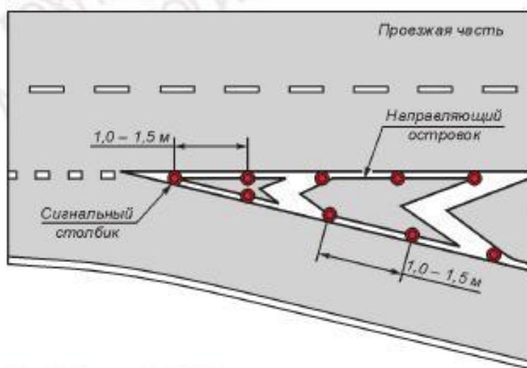
Рисунок 9 — Установка столбиков на направляющих островках
