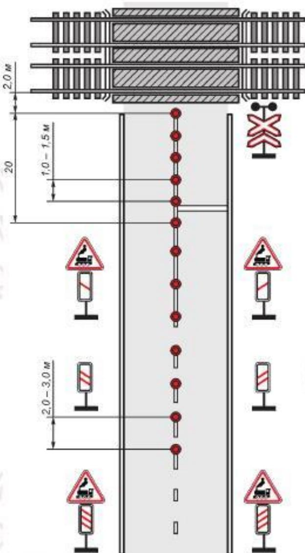
Рисунок 11 — Размещение столбиков на подходе к железнодорожному переезду
