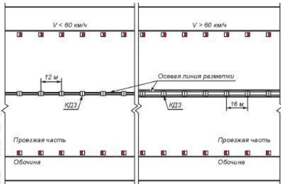
Рисунок 2 — Схема размещения световозвращателей типа КДЗ на дорогах с одной и двойной сплошными осевыми линиями разметки
